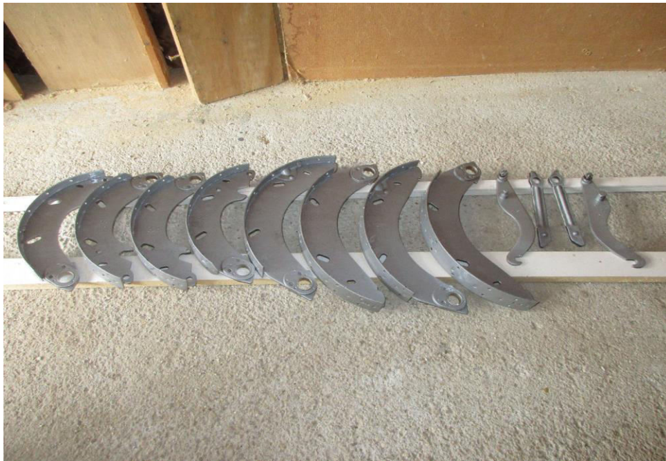
Mise en peinture des segments
