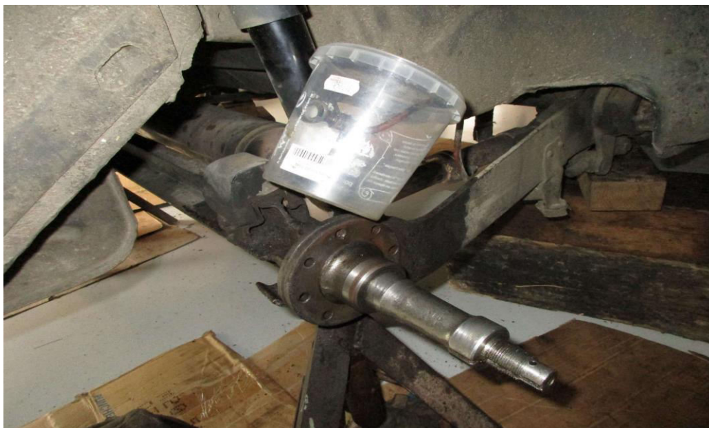
Petite astuce, pour éviter au lookéed de couler partout une fois le circuit ouvert, positionnez des pots de miel vides en extrémité des conduits arrières et des flexibles avant
