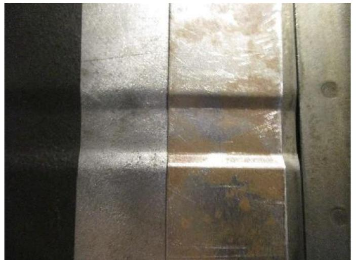
Mise en place de la matrice avec adaptation, sur une plieuse ancienne de 100 tonnes dans une entreprise locale de métallerie, réalisation du premier embouti, la butée de la seconde nervure est déjà réglée.
