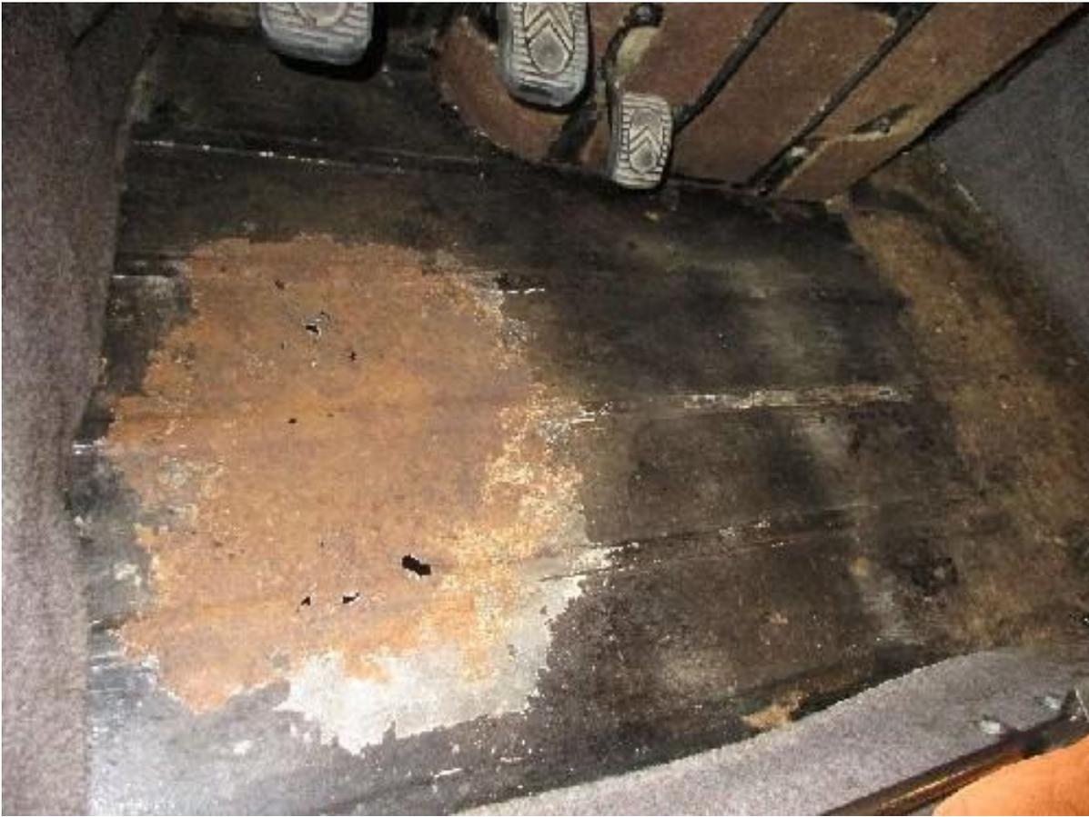
Ponçage du plancher avant, les parties rouillées sont en creux, cela délimite la zone à changer.
