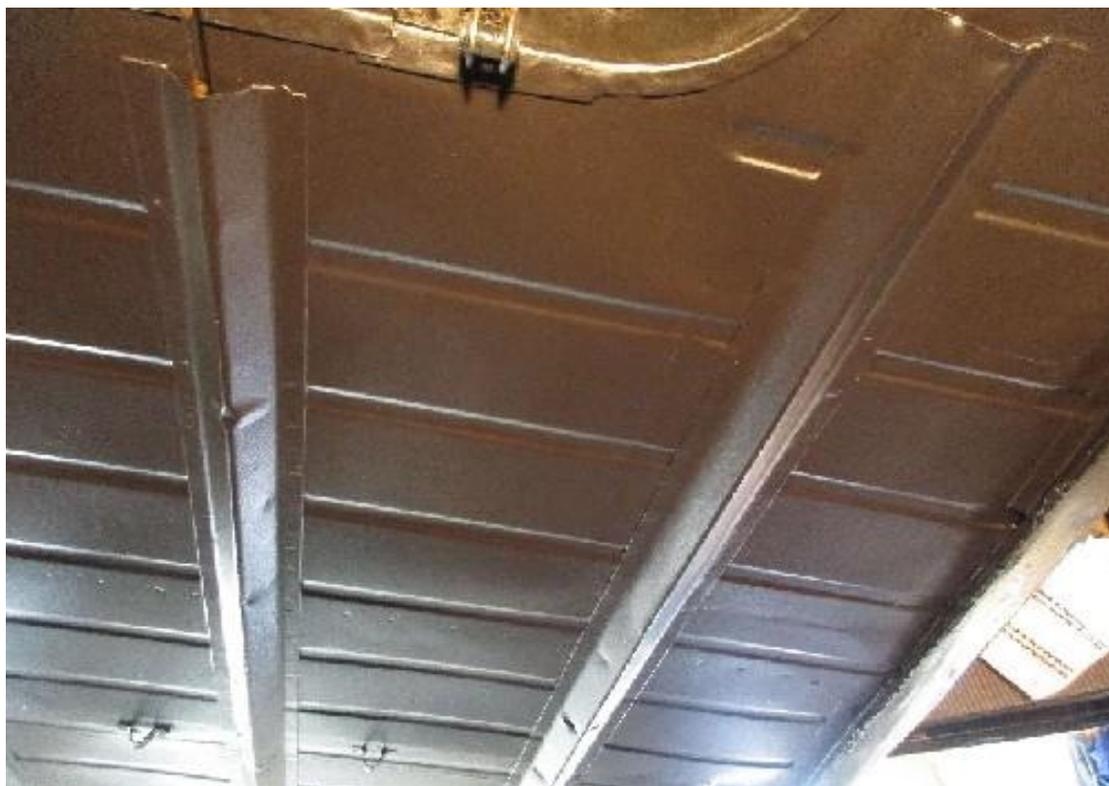
Projection d'un anti-gravillons sous le plancher, remontage des câbles, tube d'échappement et nouvelles tuyauteries dans le renfort sous plancher gauche, maintenant exempt de corrosion, c'est reparti pour de nombreuses années.
