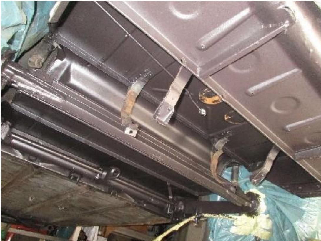
Purge de la partie avant, étonnamment il n'y a aucune protection dans les zones de contact, la tôle d'origine n'est pas attaquée par la rouille, au moins dans les zones où l'humidité ne stagne pas.
