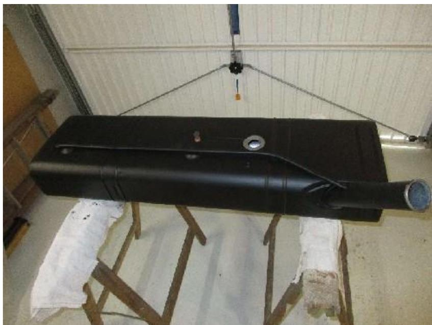
Des criques sont apparues sur le silencieux d'échappement, dûes aux vibrations, quelques soudures et un renfort vont y remédier, plus un brossage en règle pour redonner de l'éclat.
