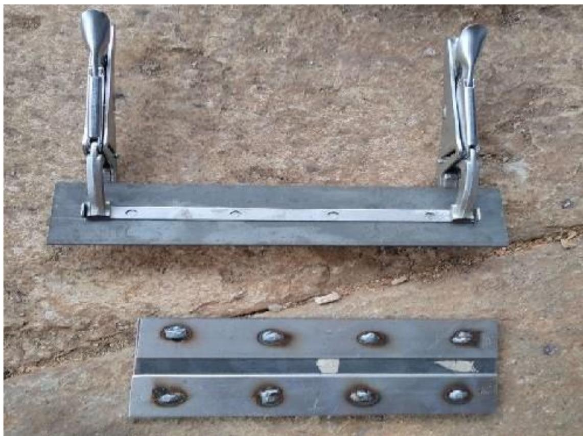
La matrice terminée avec sa butée réglable, essai d'emboutissage à l'étau sur un échantillon.
