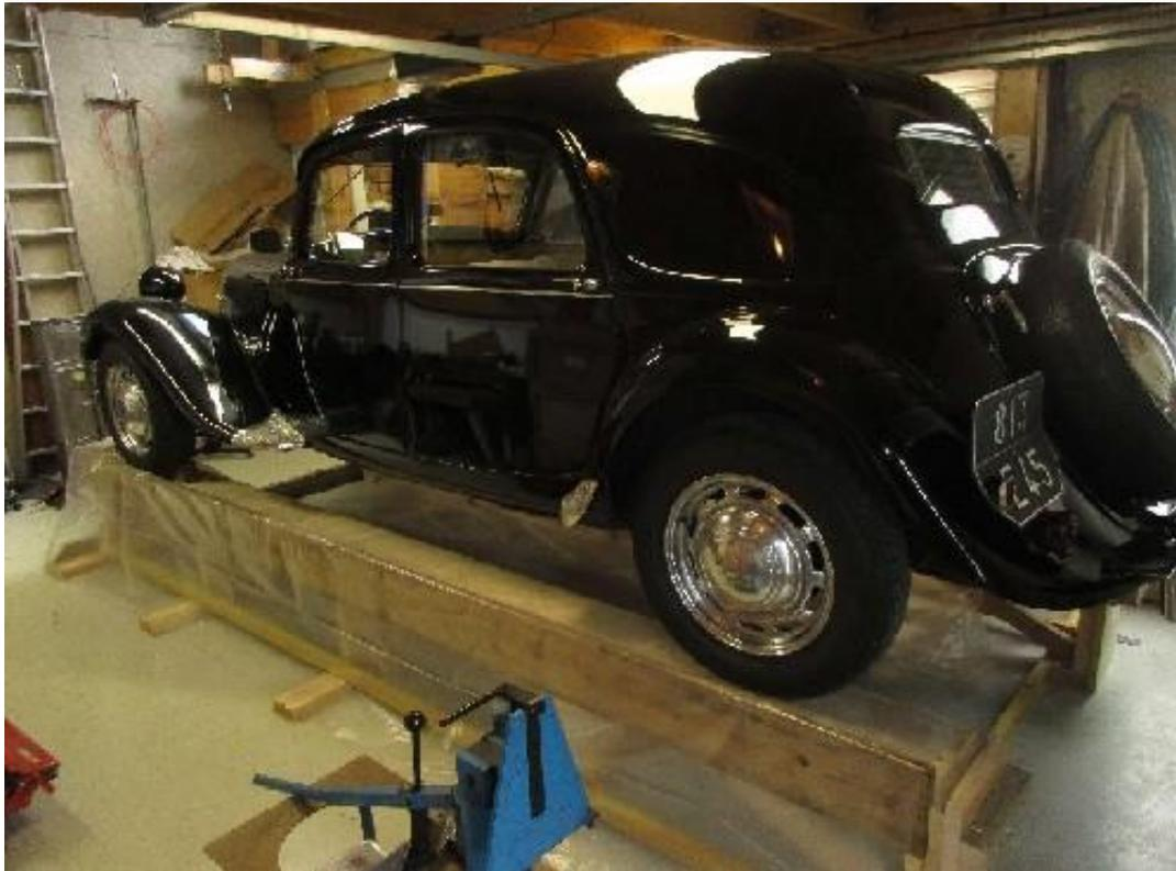
Démontage de tout ce qui peut se démonter, échappement, circuits d'essence et de freins ,tirant d'essieu etc, et remise en état immédiate et systématique de chacun des éléments.
