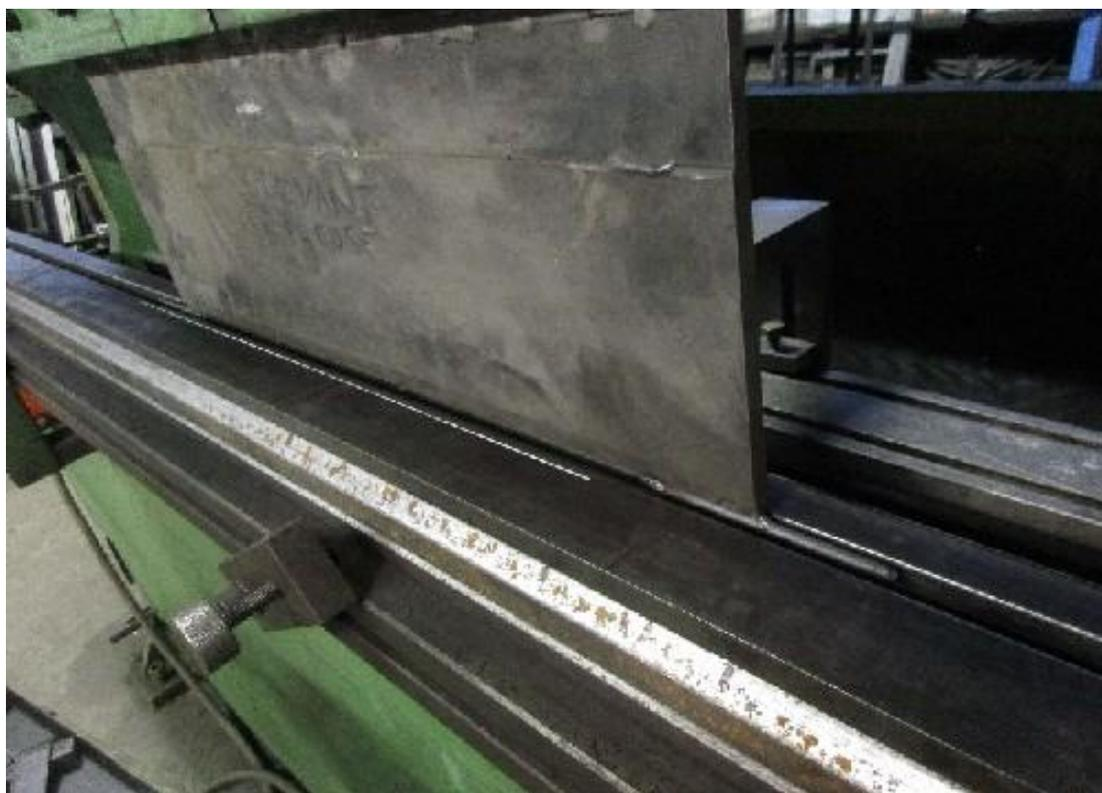
La pièce refabriquée ( à gauche ) d'un fournisseur de pièces de Traction n'est pas conforme, car pliée et non emboutie.
