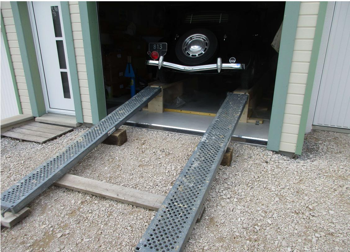
Cela passe à 5 cms sous la barre de la porte sectionnelle, la hauteur est de 2,08 ml la Traction mesure 1,54 ml de haut, elle est relevée de 49 cms, le point bas du premier panneau de la porte est à 1,99 ml et cela ne touche pas le pavillon dans l'ascension.
